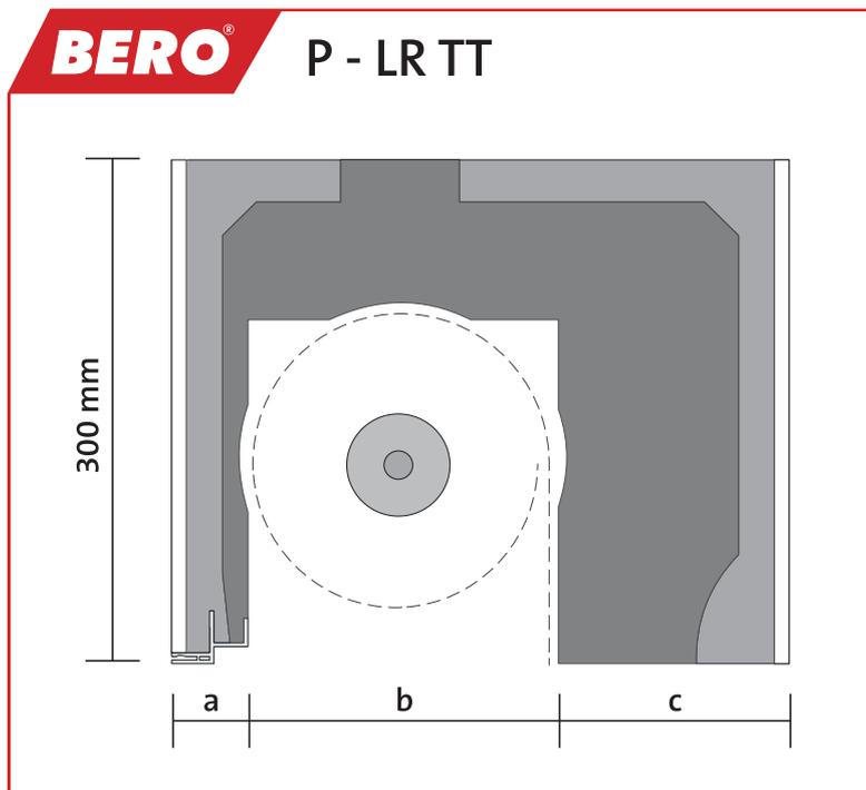
Selbsttragender Rollladenkasten aus bewehrtem BEROpor-Leichtbeton mit fest einbetonierten Porenbetonblenden und einer **äußeren Montageöffnung** für einen linksrollenden Rollladen.
